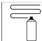
Trockenfilmschichtdicke 40 µm
