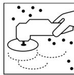
Für den Trockenschliff mit Maschine wird die Verwendung von Softscheiben mit Schaumrücken oder von Netzschliffscheiben empfohlen.
