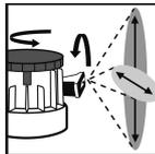
Variablen Sprühkopf auf Schadensgröße und Schadenslage einstellen.
