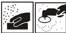
Alle eventuelle Roststellen genau reinigen und mit Schleifpapier P320-P500 trocken schleifen. Die Übergangsbereiche der alten Lackbeschichtung ausgleichen. Untergründe und alte Lackbeschichtungen nass schleifen - P600-P800.
